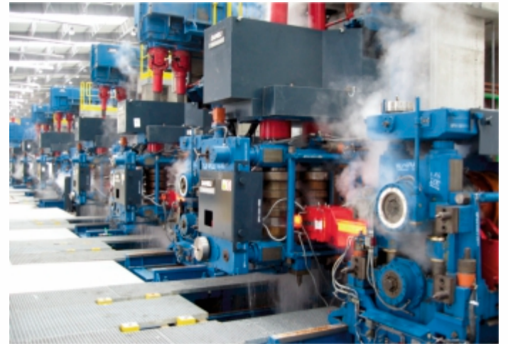
Klatki walcownicze podczas uruchomienia ciągu w 2008 roku
